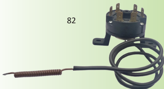
Termostato di limite alto a 3 poli a reset manuale, a sicurezza intrinseca, impostazione fissa, intervallo di temperatura fino a 170°C
